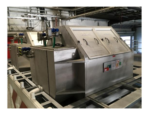
deutlich um ca. 80% reduziert und die Filtrationseffizienz gesteigert werden. Die Menge der Feststoffe wurde von  $900 \, \text{mg/l} \, \text{auf} < 500 \, \text{mg/l} \, \text{reduziert}.$
